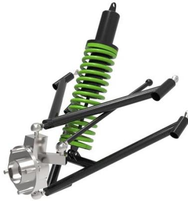
Figura 2 – Desenho em CAD da suspensão Duplo A
