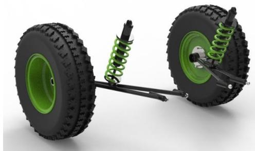
Figura 13 – CAD da suspensão traseira
