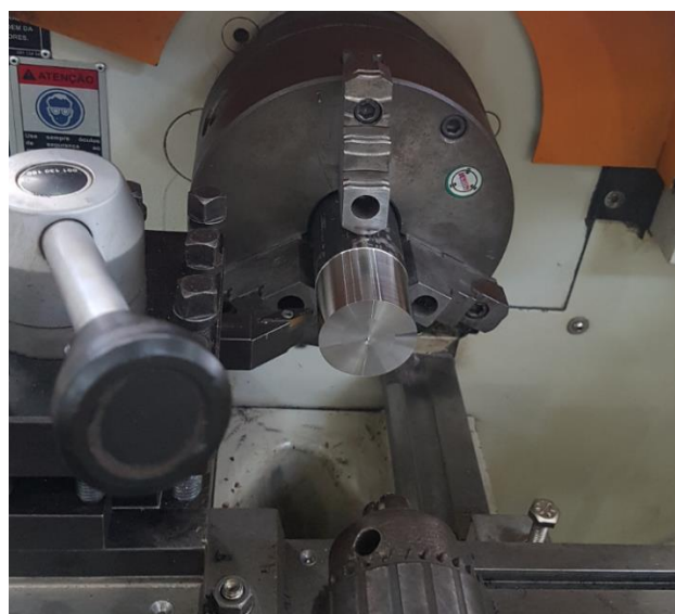
Figura 62 - Usinagem externa da bucha do braço 1.
