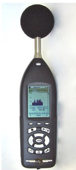
Figura 23 - Medidor de nível sonoro Larson Davis Soundtrack LxT (Disponível em: http://www.mip.fi/cms/fi/mittalaitteet/melu-ja-aeaeni/aeaenitasomittarit/tarkkuusluokka-2-mittarit/309-larson-davis-soundtrack-lxt-aeaenitasomittari ).
