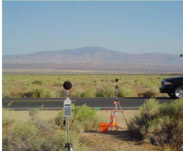
Figura 32 - Medição de ruído pelo método controlado de passagem (Judith Rochat, U.S. DOT Volpe Center apud BERNHARD et al. , 2005).
