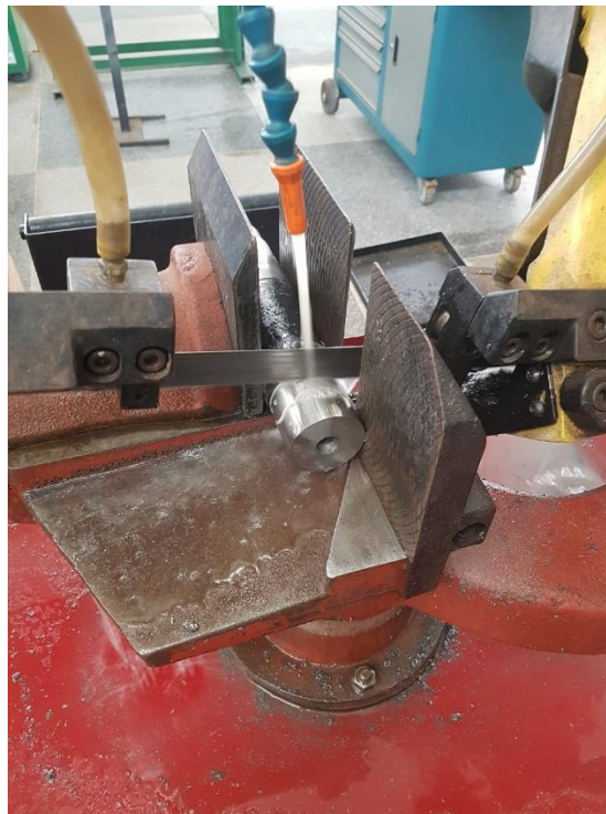
Figura 64 - Corte da bucha do braço 1 na serra fita.
