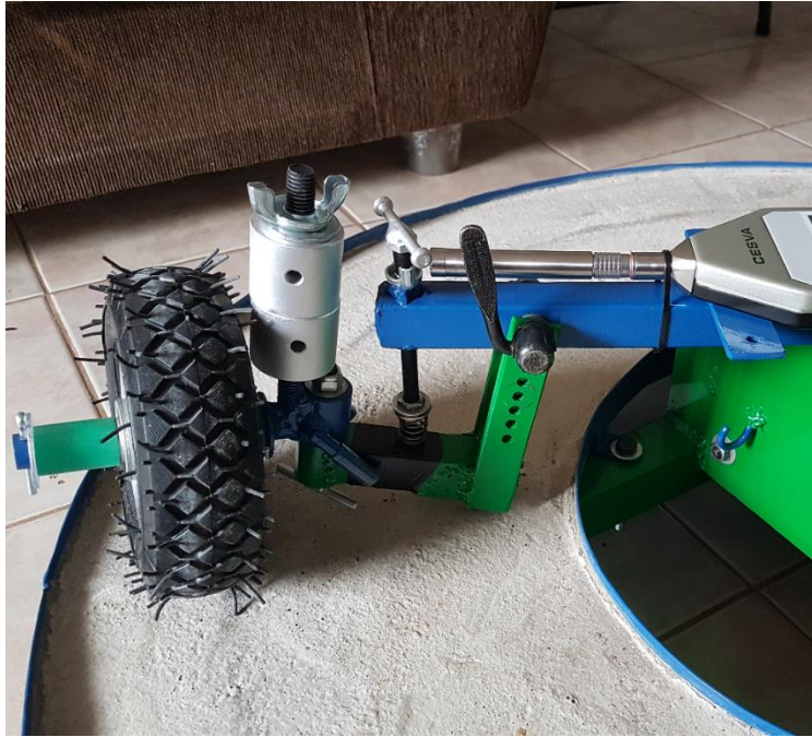
Figura 81 – Roda com ângulo de cambagem negativo.
