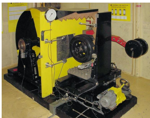
Figura 37 - Dispositivo de teste de ruído pneu-pavimento pelo método do tambor giratório (SANDBERG et al. , 2013).
