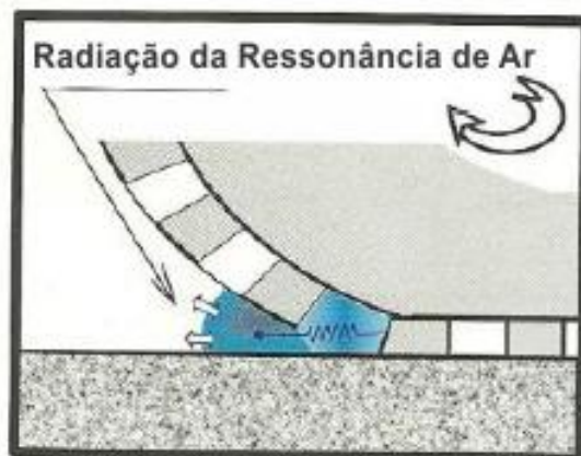
Figura 17 - Radiação da ressonância de ar na parte traseira do pneu (SILVA, 2011) (Adaptado).
