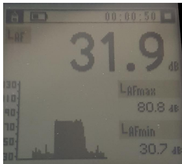
Figura 76 – Resultados da medição com ângulos de cambagem e convergência neutros e sem carga adicional no conjunto roda e pneu.
