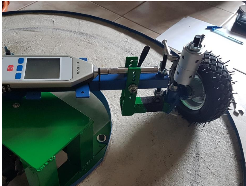
Figura 79 – Pesos adicionados ao braço do dispositivo.
