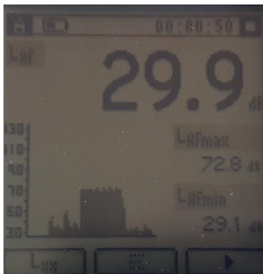
Figura 74 – Resultado da medição sem roda e pneu acoplados.
