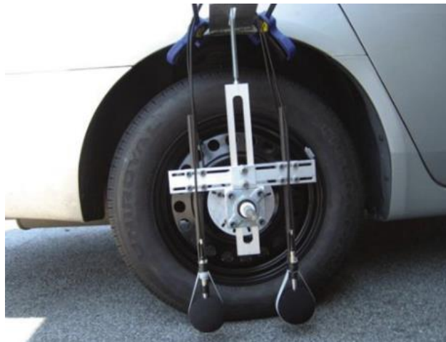
Figura 33 - Medição de ruído pelo método CPI (WANG et al. , 2012).
