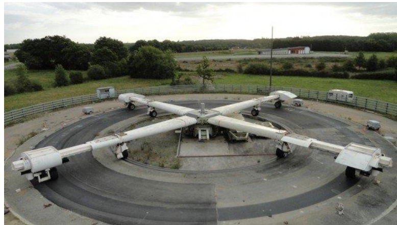
Figura 38 - Dispositivo para teste de durabilidade de pavimentos (CORTÉ, 2001).
