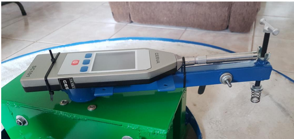
Figura 73 – Sonômetro acoplado ao braço 1 do dispositivo, com roda e pneu desacoplados.
