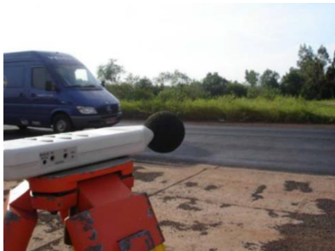
Figura 5 - Medição de ruído pelo método estatístico de passagem (SPECHT et al. , 2009).
