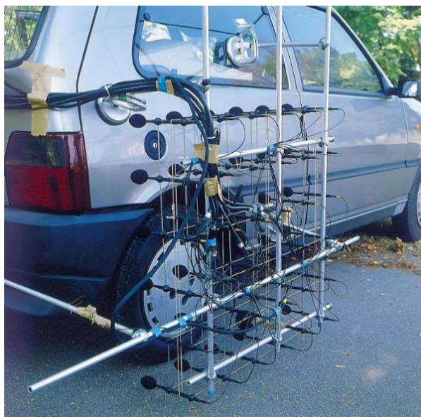
Figura 4 - Equipamento para teste de ruído pneu-pavimento (RASMUSSEN et al. , 1996).
