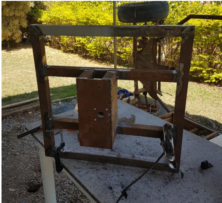
Figura 61 - Chapas de fixação do motor soldadas à estrutura.
