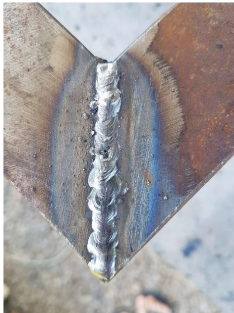
Figura 60 - Cordões de solda por eletrodo revestido na estrutura da bancada.
