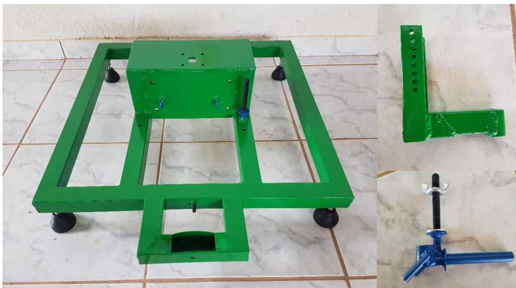
Figura 67 – Peças após aplicação da camada final de tinta PU.
