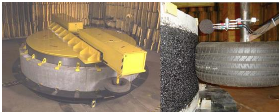
Figura 36 - Dispositivo para teste de ruído pneu-pavimento em laboratório (BERNHARD et al. , 2005).
