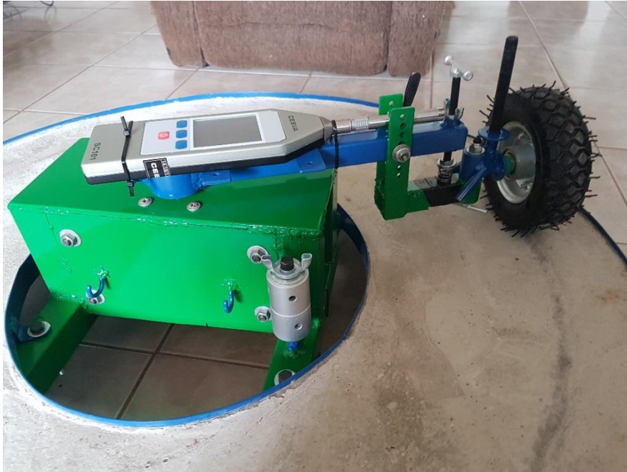
Figura 75 – Dispositivo com ângulos de cambagem e convergência neutros e sem carga adicional no conjunto roda e pneu.
