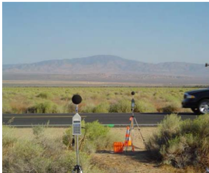
Figura 6 - Medição de ruído pelo método controlado de passagem (Judith Rochat, U.S. DOT Volpe Center apud BERNHARD et al. , 2005).
