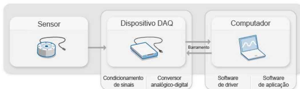
Figura 25 - Sistema de aquisição de dados (Disponível em: http://www.ni.com/data-acquisition/what-is/pt/ ).
