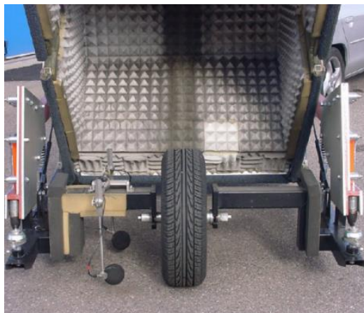
Figura 34 - Medição de ruído pelo método CPX (SLAMA, 2012).
