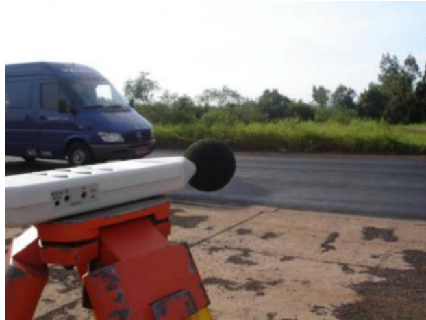
Figura 31 - Medição de ruído pelo método estatístico de passagem (SPECHT et al. , 2009).
