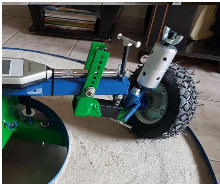
Figura 82 – Roda com ângulo de cambagem positivo.
