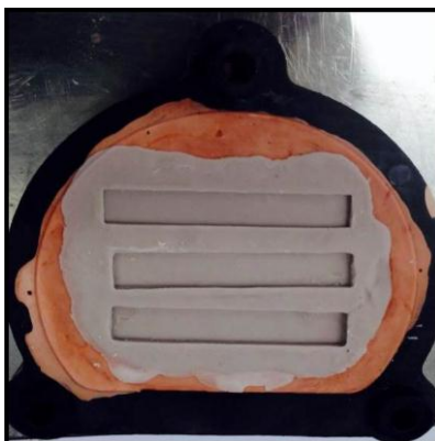
Figura 1 - Moldes em silicone Zetalabor (Zhermack, Itália) e gesso pedra, no interior de mufla plástica, para técnica de polimerização em micro-ondas
