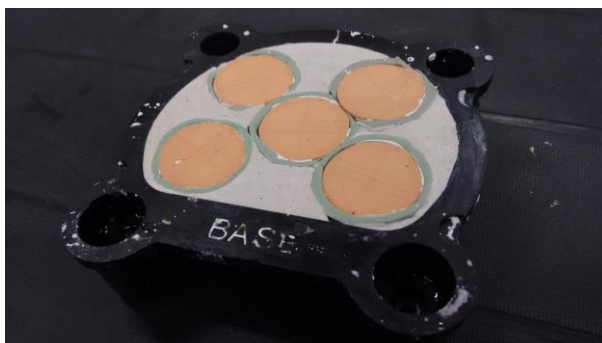
Figura 5 – Base da mufla plástica para micro-ondas com os moldes da matriz metálica em silicone de adição
