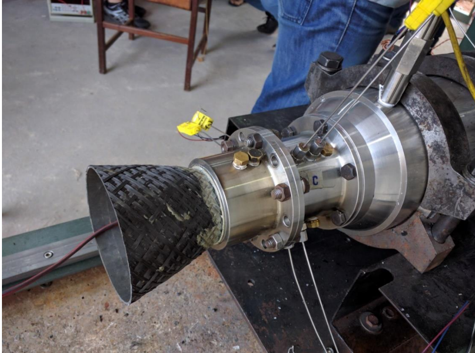
Figura 133: Ensaio de um motor de foguete com uma tubeira de fibra de carbono.
