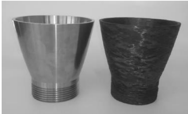
Figura 11: Tubeira de Aço 304L e plástico reforçado com fibra de carbono (Andrianov et al., 2015).
