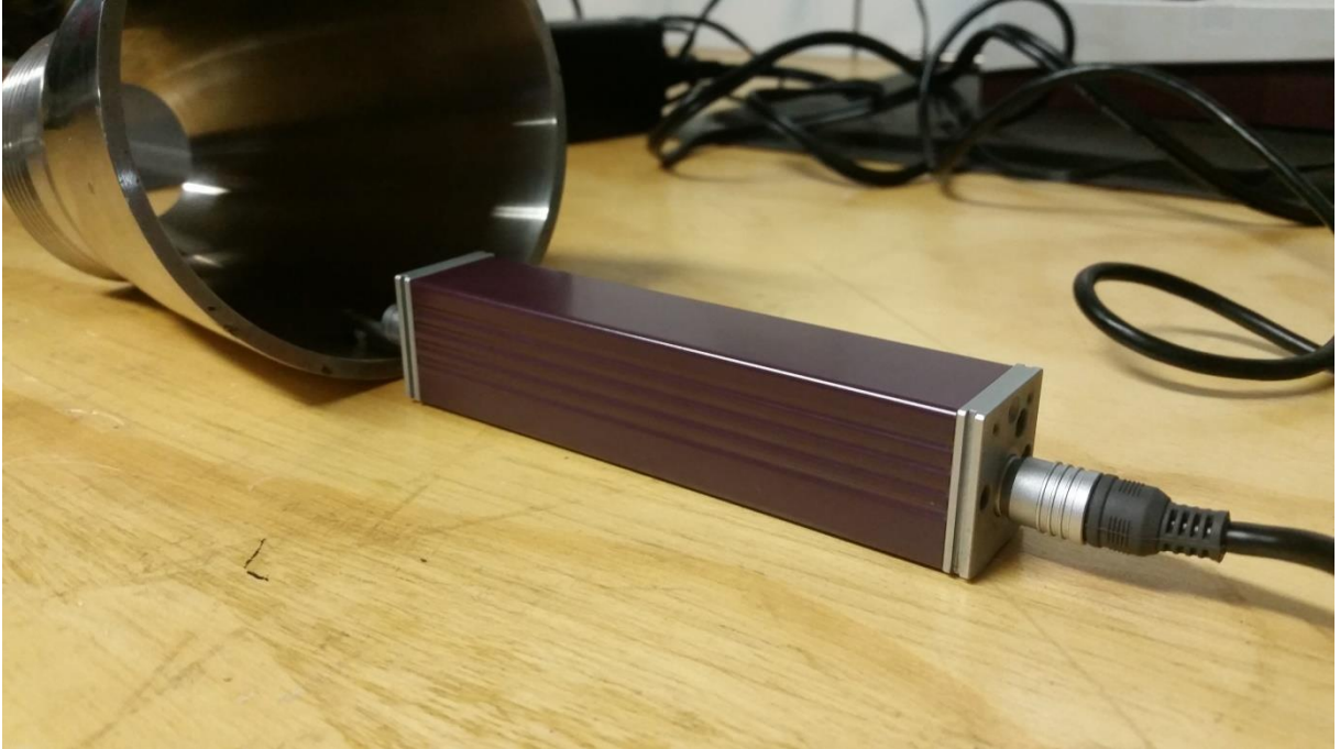
Figura 122: Medição da rugosidade e ondulação da tubeira de aço no fim da tubeira.
