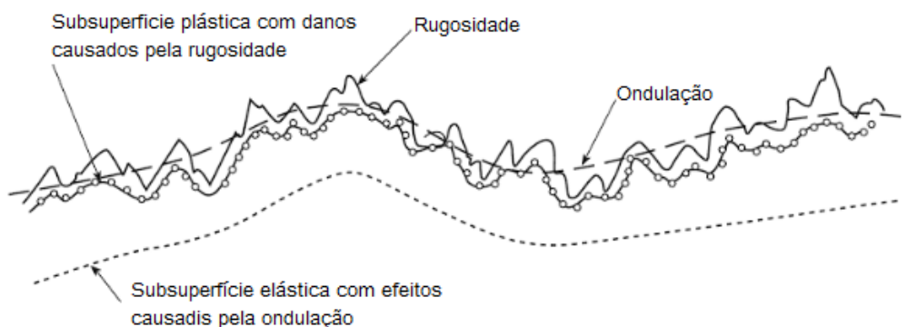
Figura 19: Ondulação, rugosidade e seus efeitos. (Whitehouse, 1994).
