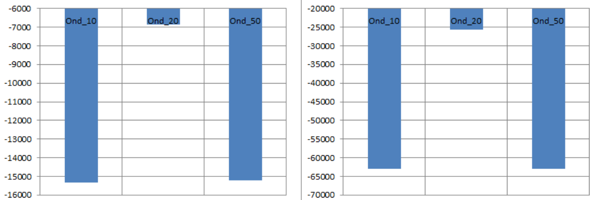
Figura 48: Pressão do fluxo dentro da tubeira para os pontos 124mm e 380mm
