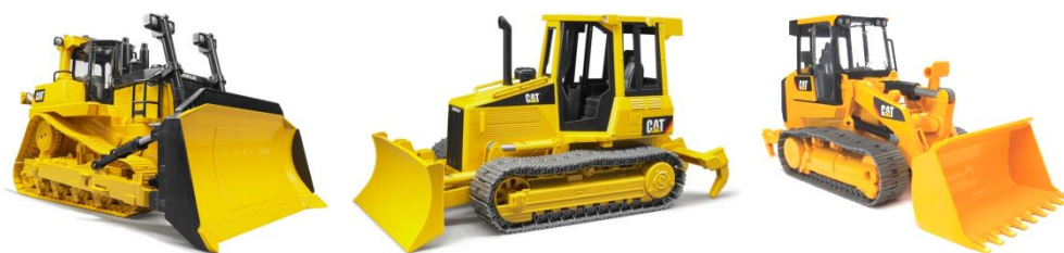
Figuras 26, 27 e 28. Bulldozer, à esquerda; trator de esteiras, no meio; e carregadeira de esteiras, à direita. Retiradas da internet 38 .
