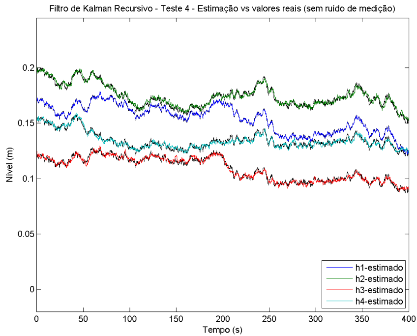
Figura I.17: Filtro de Kalman recursivo - Teste 4 - Comparação entre a estimação e os níveis reais dos tanques (sem ruído)
