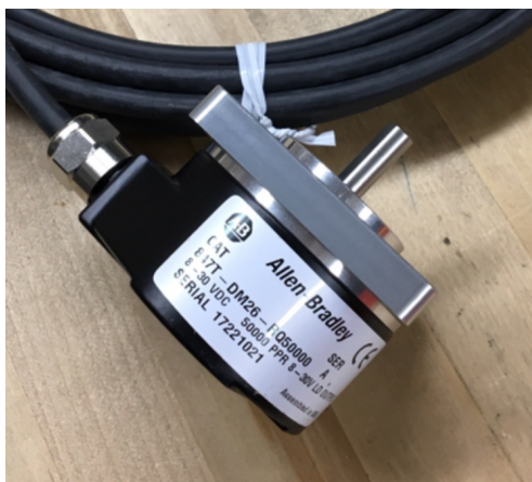
Figura 3.5: Encoder do modelo 847T-DM26-RQ50000 da fabricante Allen-Bradley.
