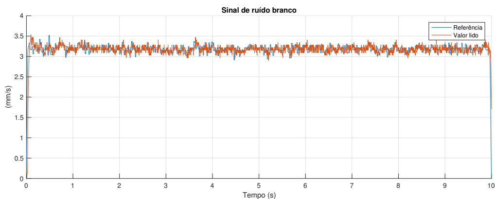
Figura 7.7: Perfil de velocidade de injeção para sinal de ruído branco.
