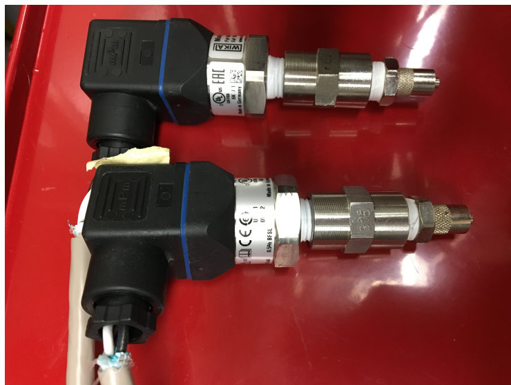
Figura 3.4: Sensores de pressão do modelo A-10 da fabricante WIKA.
