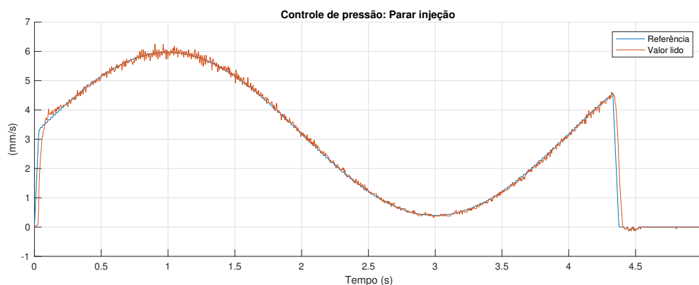
Figura 7.14: Teste do controle de pressão para o método que para o procedimento.
