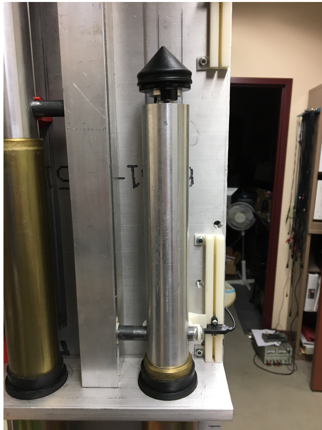
Figura 2.5: Conector do atuador ao êmbolo da seringa.
