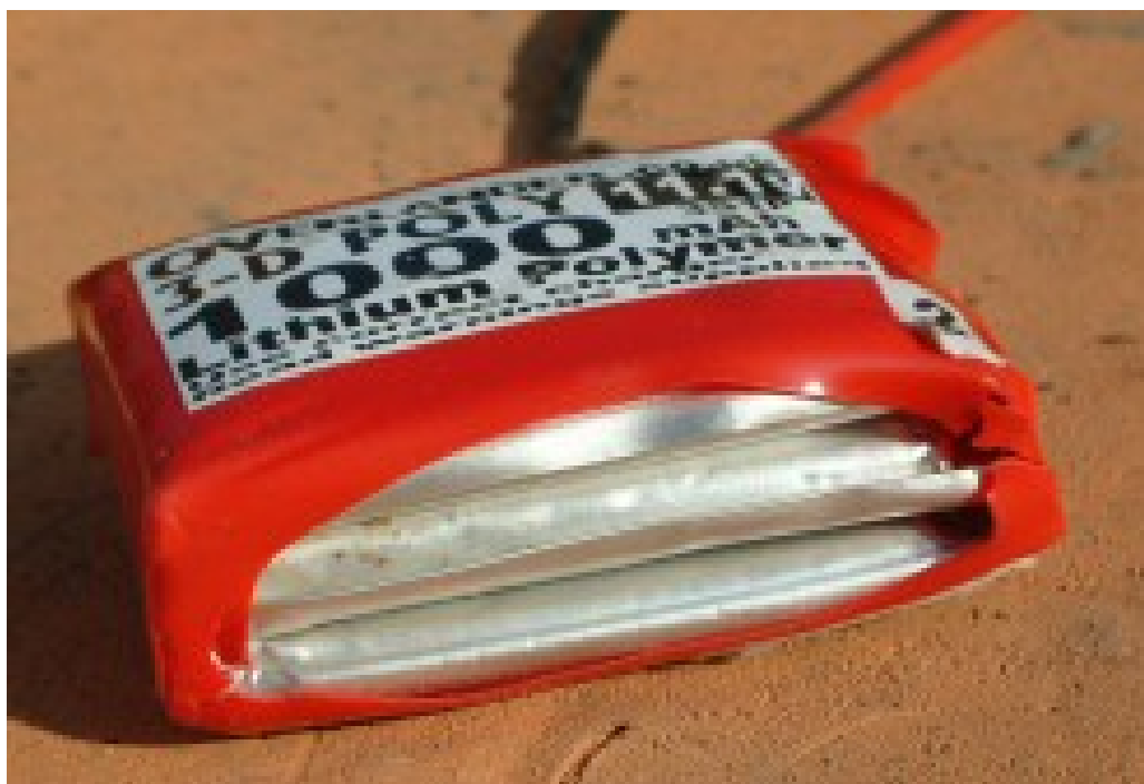
Figura 2.7. Bateria LIPO “estufada” após sobrecarga.
