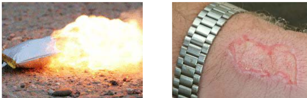
Figura 2.8. Riscos possíveis: (a) Bateria LIPO explodindo; (b) Pessoa ferida após curto circuito.
