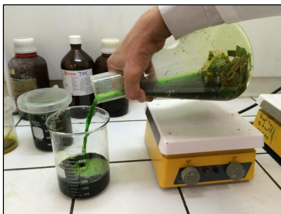
Figura 6. Lixiviação com água régia
