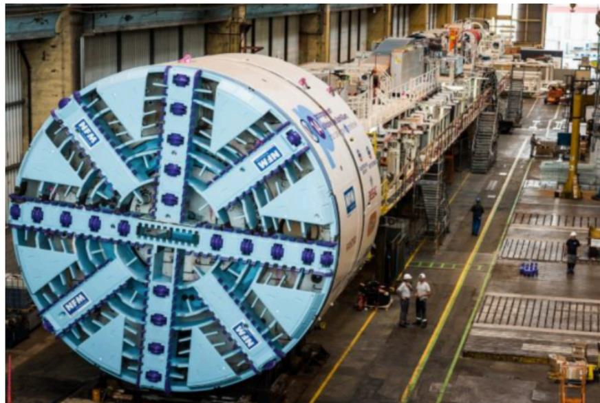
Figura 2.7 - Uma TBM, máquina de escavação de túneis (Tunneling Journal, 2016)
