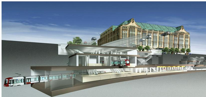
**Figura 2.4 - Ilustração de uma estação de metrô abaixo de linha rodoviária superficial em Dusseldorf, Alemanha (Schuessler, 2016)**
