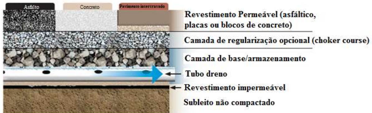
Figura 2-3 – Seção transversal de um pavimento permeável sem infiltração. (Adaptado de EISENBERG, LINDOW, SMITH, 2015)
