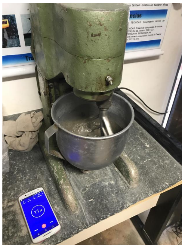
Figura 3.9 - Mistura da água, superplastificante, cimento, argila e fíler
