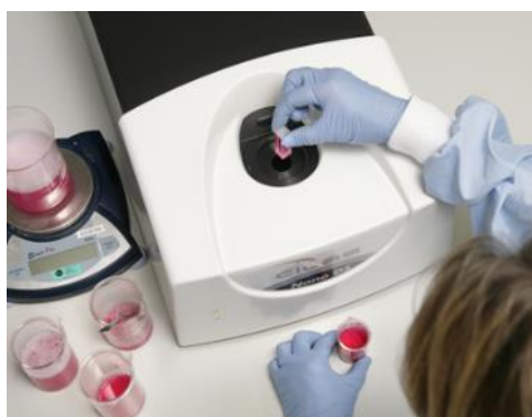
Figura 3.2 – Aparelho utilizado no ensaio de granulometria a laser.
