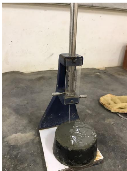
Figura 3.8 – Aparelho de Vicat no ensaio de tempo de início de pega
