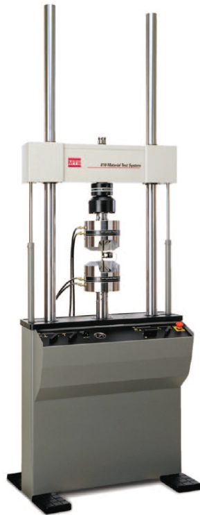
Figura 2.4: Máquina tração torção MTS (Fonte: MTS 810 and 858 Material Testing Systems, 2006).
