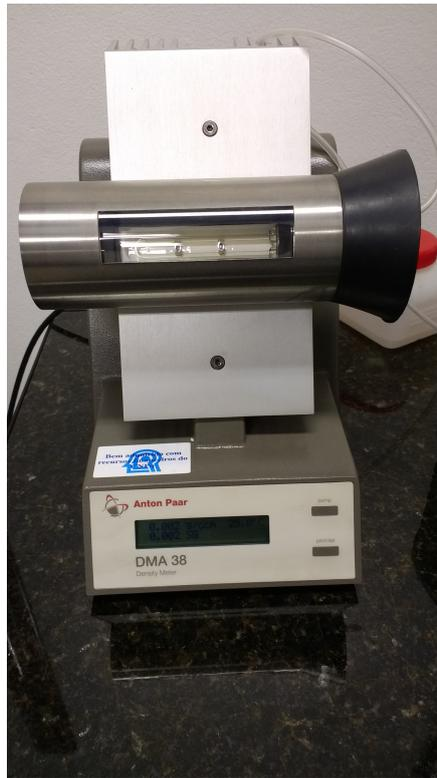
Figura 4.8 – Densímetro DMA 38, da marca Anto Paar, utilizado neste experimento.
