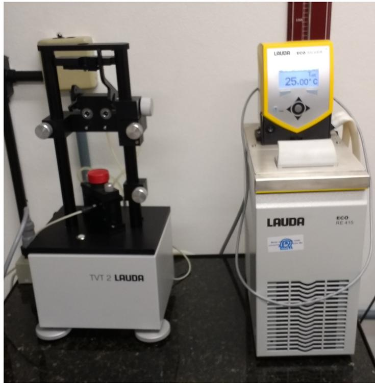
Figura 4.9 – À esquerda tensiômetro LAUDA TVT 2 e à direita banho térmico LAUDA ECO RE 415. Verifica-se também a temperatura sob a qual os experimentos foram realizados.
