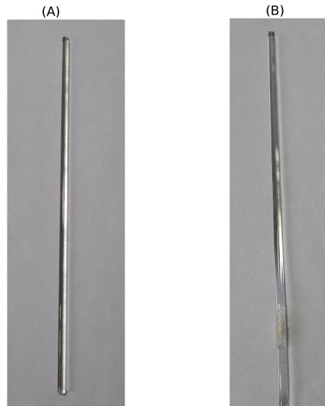
Figura 4.5 – (A) Tubo capilar com di metro externo de  $3 \pm 0,2$ mm, di metro interno de  $50 \pm 2\mu\text{m}$  e comprimento de 150mm. (B) Tubo capilar com di metro externo de  $3 \pm 0,2$ mm, di metro interno de  $50 \pm 2\mu\text{m}$  e comprimento de 150mm. Verifica-se a presen a do filme de PVC pr ximo   base do tubo.
