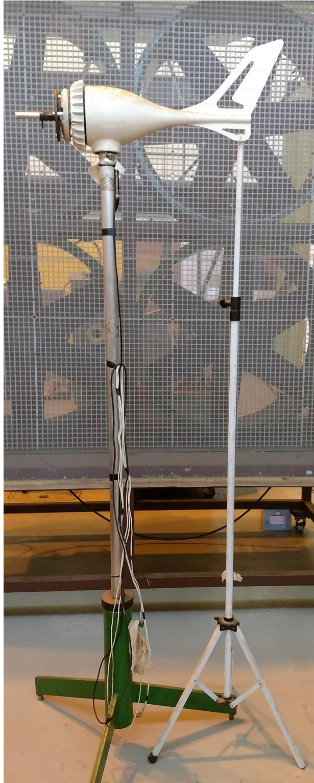
Figura 7.2 - Haste utilizada para estabilização da cauda da turbina
