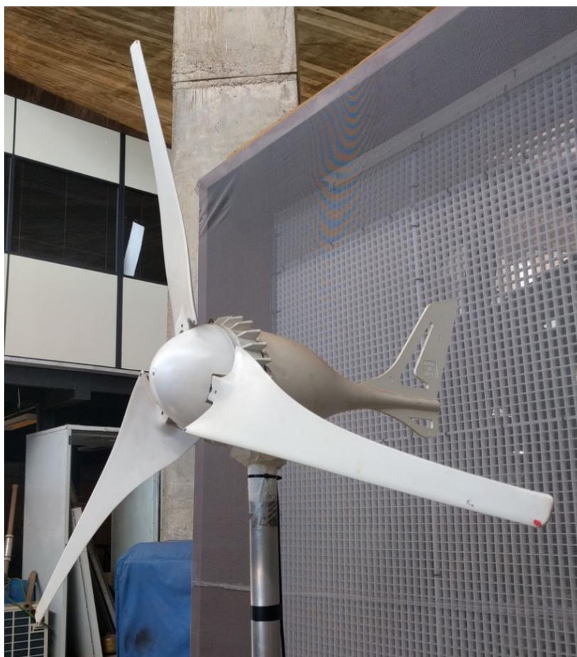
Figura 4.2 - Turbina eólica iSTA Breeze® i-500
