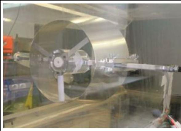
Figura 3.11 – Difusor montado sem bocal.
