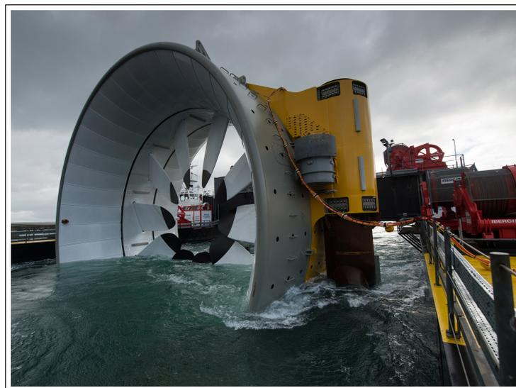
Figura 1.7 – Turbina marítima de eixo aberto. Projeto desenvolvido pelo consórcio DCNS/OpenHydro/EDF. Aproximadamente 1MW - 20 m de diâmetro
