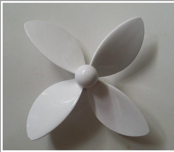
Figura 5.3 – Rotor de quatro pás.
