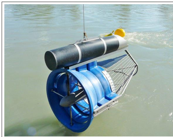
Figura 1.2 – Turbina de eixo horizontal desenvolvida pela empresa Smart Hydro Power. Potência de 250 W a 5 kW - 380 kg - 1m de diâmetro.
