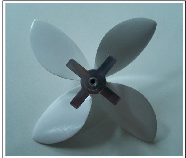
Figura 5.4 – Rotor de quatro pás visto por trás.
