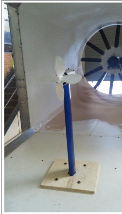
Figura 5.7 – Turbina HK-10 no interior do túnel de vento.
