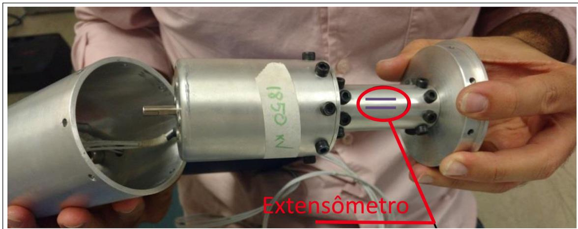
Figura 5.9 – Torquímetro visto internamente com extensômetro em destaque.
