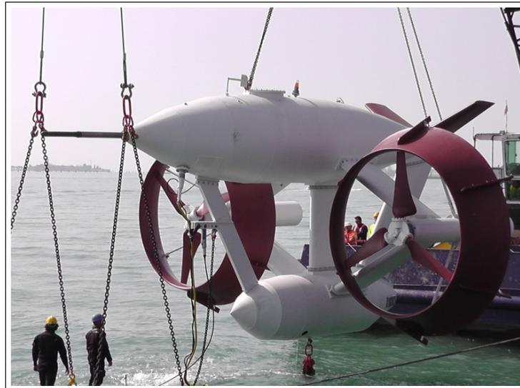
Figura 1.6 – Turbina marítima GEM. Desenvolvida pela ADAG. Aproximadamente 100 kW - altura: 5.2 m, largura: 10.4 m e comprimento: 9.2 m.
