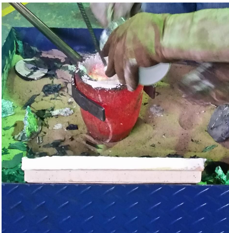
Figura 3.8. Agitação e deposição da escória no alumínio fundido.
