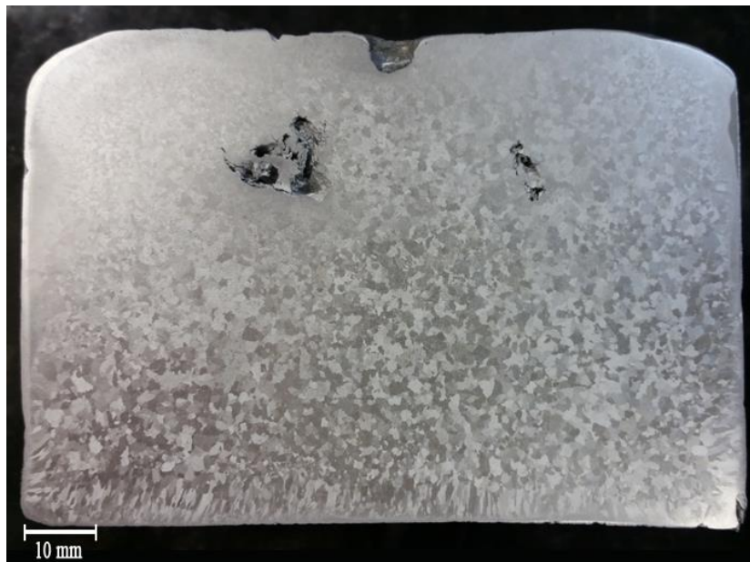
Figura 4.4. Face do lingote com adição de escória após ataque químico com Keller.
