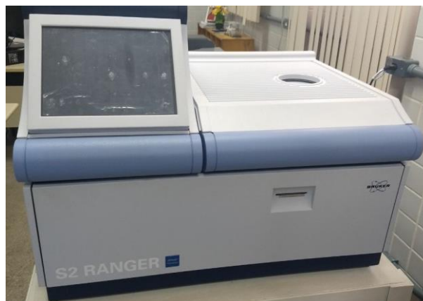
Figura 3.15. Equipamento Bruker S2 RANGER utilizado para o teste FRX.
