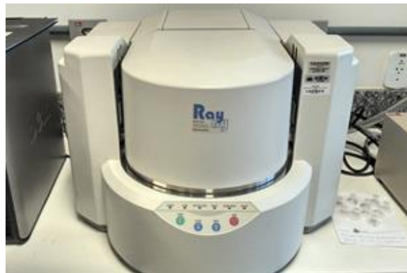
Figura 3.14. Equipamento EDX 720HS utilizado para o teste EDX. [ http://caiq.unb.br ]
