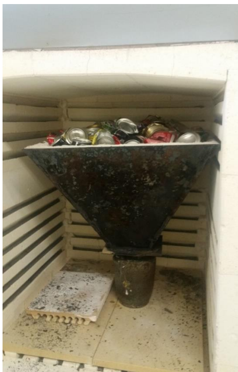
Figura 3.4. Latas de alumínio no funil posicionado sobre o cadinho antes da fundição.
