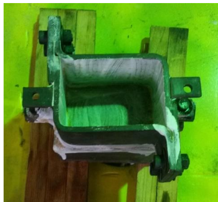
Figura 3.3. Lingoteira utilizada para receber o material fundido.
