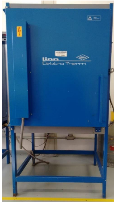
Figura 3.2. Forno mufla utilizado para fundição.
