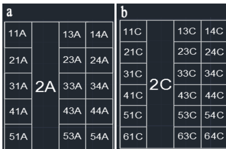
Figura 3.16. Desenho esquemático da numeração das peças fatiadas do lingote (a) sem adição de escória e (b) com adição de escória.
