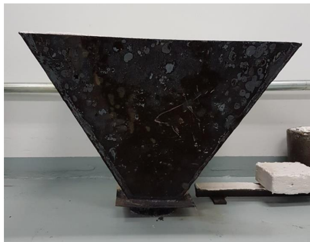
Figura 3.1. Funil utilizado para fundição das latas.
