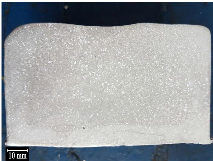
Figura 4.5. Face do lingote sem reforço após ataque químico com Flick e \text{HNO}_3 .
