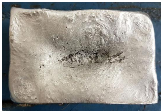
Figura 4.1. Rechupe presente no lingote sem reforço.
