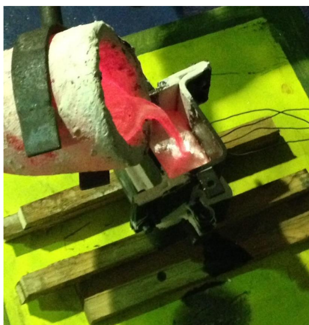
Figura 3.9. Conteúdo do cadinho sendo vertido na lingoteira.
