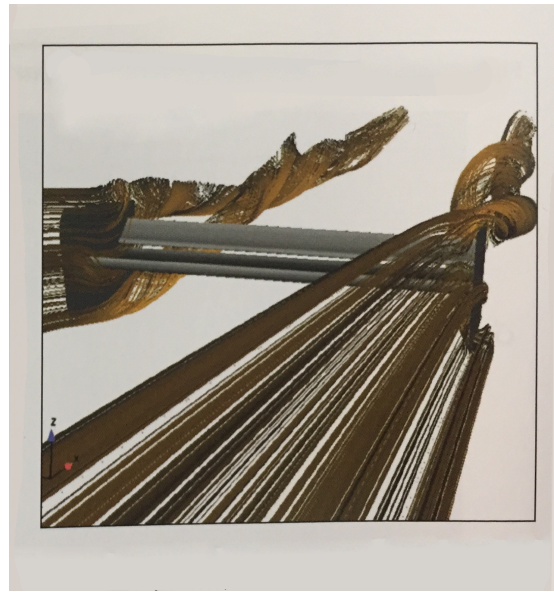
(c) Formação do edge vortex para uma wing com end plates
