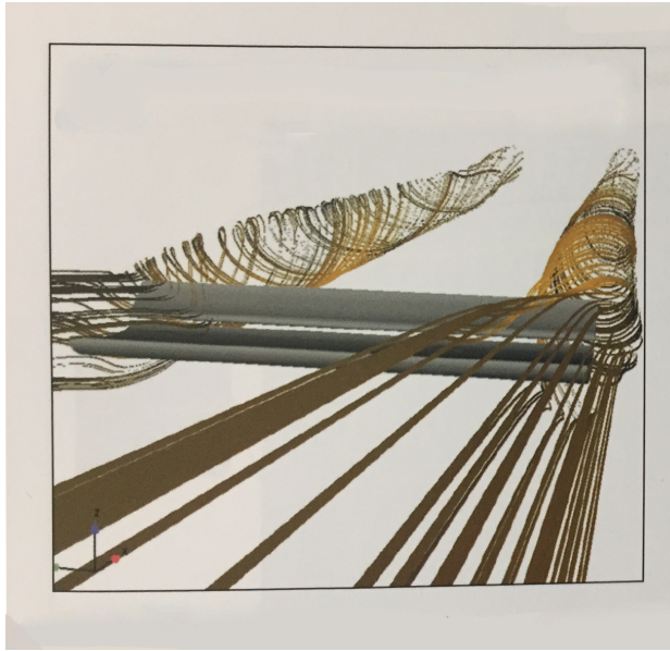
(b) Formação do vórtice ponta de asa para uma wing
