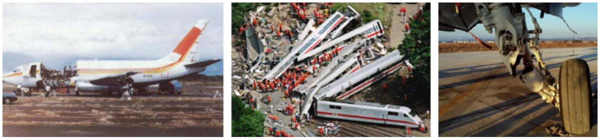
Figura 1-1. Exemplos de acidentes por falha de fadiga (a) Acidente durante o voo 243 da Aloha Airlines e (b) Acidente com o trem ICE 884 na Alemanha e (c) falha em trem de pouso.
