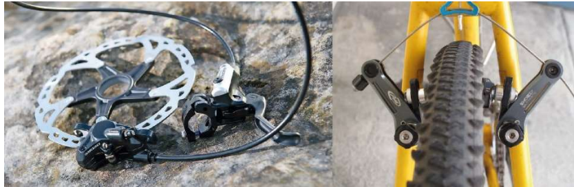
Figura 2.15: À esquerda imagem de freio a disco e à direita imagem de freio cantilever . (BikeRadar, 2014 – Lee, 2010)
