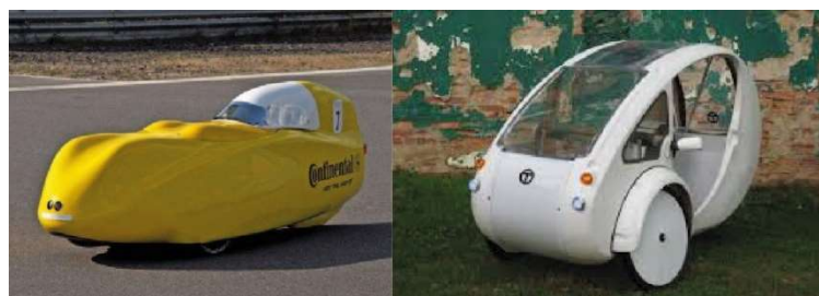
Figura 2.12: À esquerda uma imagem de um velomóvel com carenagem em tradicional formato de casco. À direita, velomóvel com carenagem alta, que proporciona mais conforto ao usuário. (Ball, 2010 – Lofgren, 2012)
