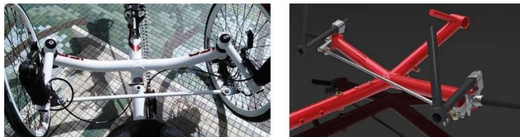
Figura 7.2: Sistema de direção direto. (Greene, 2014 – UtahTrikes)
