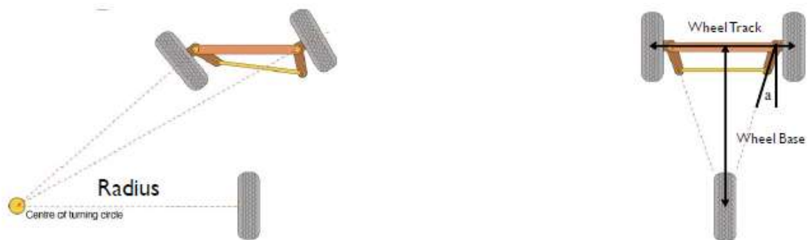
Figura 4.4: Compensação de Ackerman. (Gillespie et al, 2008)
