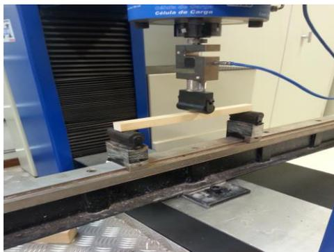
Figura 1- Máquina EMIC realizando os testes de flexão estática.
