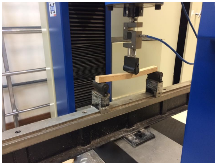
Figura 4: Ensaio de Flexão Estática na Máquina de Ensaio Universal EMIC DL 30kN.
