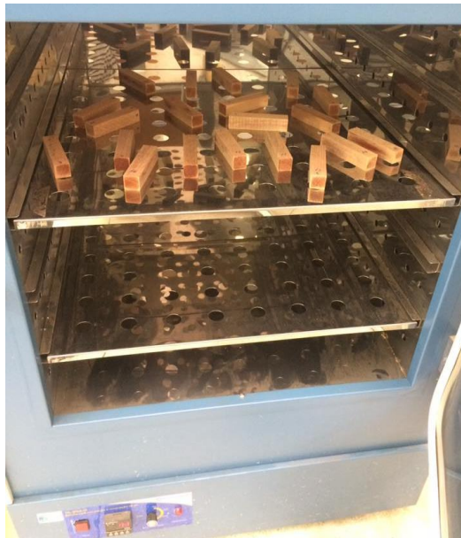
Figura 3: Corpos de prova na estufa a 103 \pm 2^\circ\text{C} .
