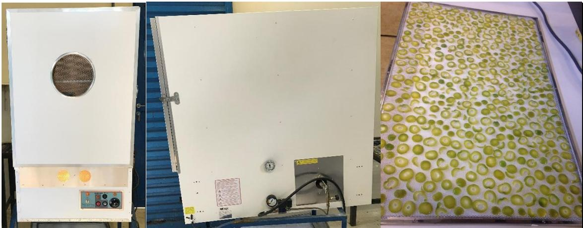
Figura 12: Desidratador elétrico modelo Pardal PEG 60. Vista frontal (à esquerda), vista lateral (centro) e secagem em batelada na bandeja com cagaitas verdes *in natura* (à direita).
