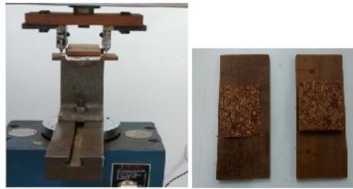
Figura 18 - Corpo de prova antes e depois da ruptura. Fotos da autora.
