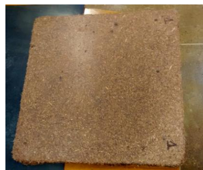
Figura 12 – Painel após a prensagem a quente. Foto da autora.
