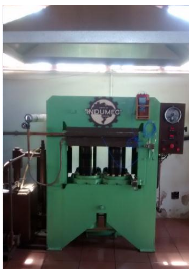
Figura 11 - Prensa hidráulica da marca INDUMEC. Foto da autora
