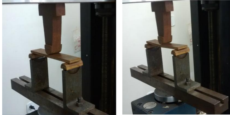
Figura 16 : Corpo de prova antes e depois da ruptura.
