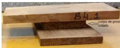
Figura 17 - Bloco para ensaio de Tração Perpendicular. Foto da autora.
