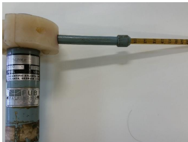
Figura 5.1: Antena Dipolo do Laboratório de Antenas – Frequência 350 a 590MHz
