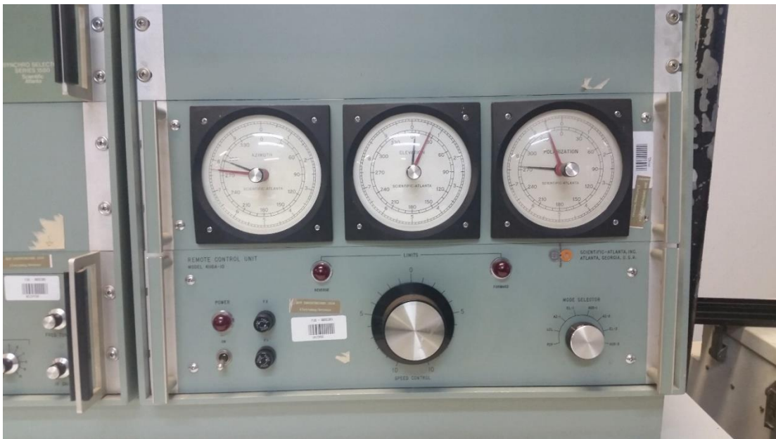
Figura 4.1: Unidade de Controle Remoto com os cursores de Azimute, Elevação e Polarização
