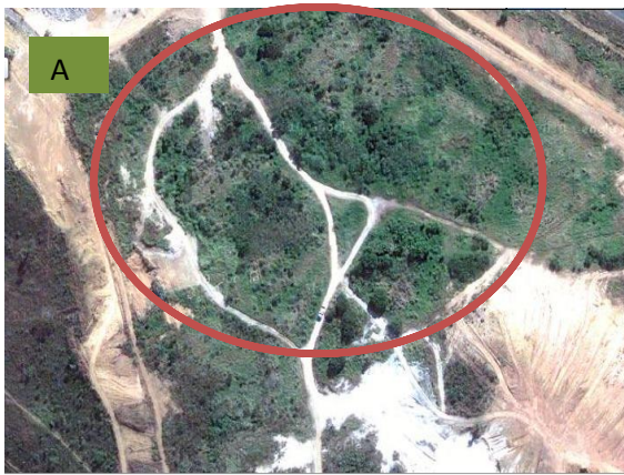
Figura 07: Vista por satélite do aterro controlado de Formosa- GO, (a) células já fechadas e reflorestadas.
