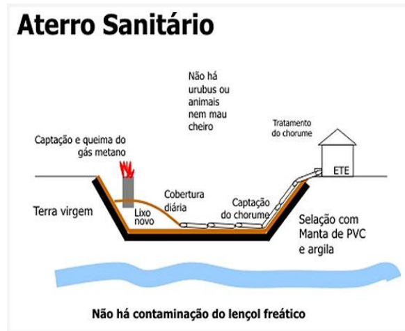
Figura 04: Estrutura do Aterro Sanitário
