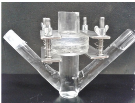
Figura 7. Célula de difusão do tipo Franz modificada (MATOS, 2014)
