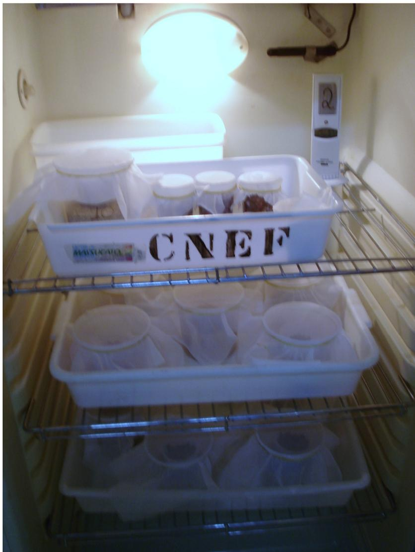
**Figura 2. Câmara climatizada (BOD) regulada a  $26,5 \pm 0,8$  °C,  $65 \pm 10\%$  U. R. e 14 horas de fotofase.**
