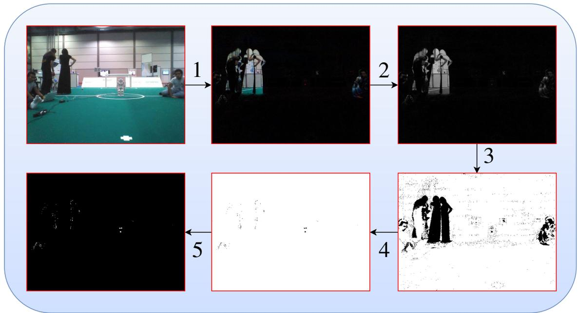
Fig. 4.9: Algoritmo utilizado para segmentação de LEDs na imagem. As operações estão numeradas da seguinte forma. 1-Subtração das imagens. 2-Conversão para escala de cinza. 3-Filtro binário. 4-OR bit-a-bit. 5-Inversão da máscara.
