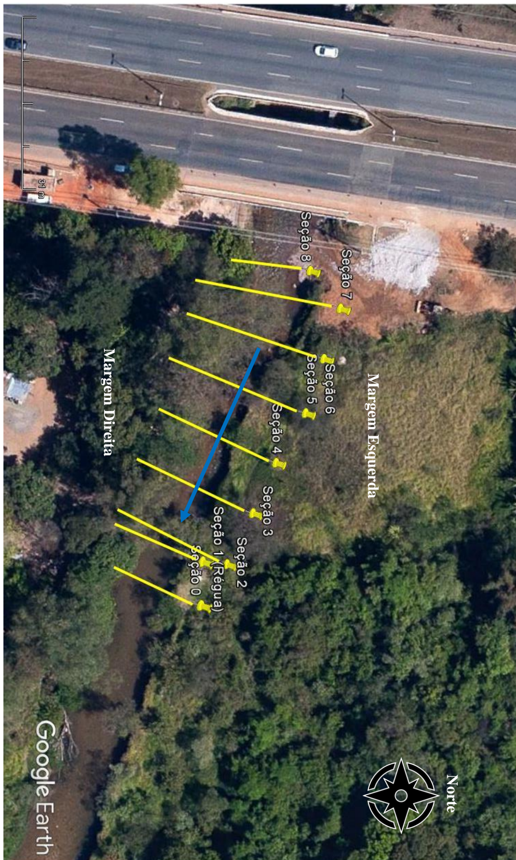
Figura 4.2 – Vista aérea obtida por imagem de satélite com a localização das seções transversais e sentido do escoamento (Google Earth, 2016)
