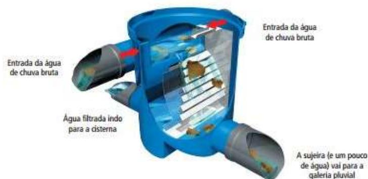
Figura 17. Dispositivo de descarte de sólidos, VF-1
