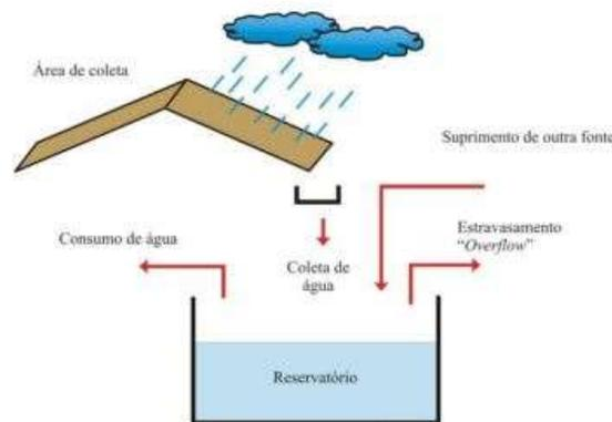
Figura 10. Esquematização do SAAP (Fonte: May, 2004)
