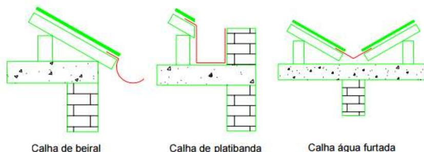
Figura 13. Tipos usuais de calhas (Fonte: Ghisi, 2015)
