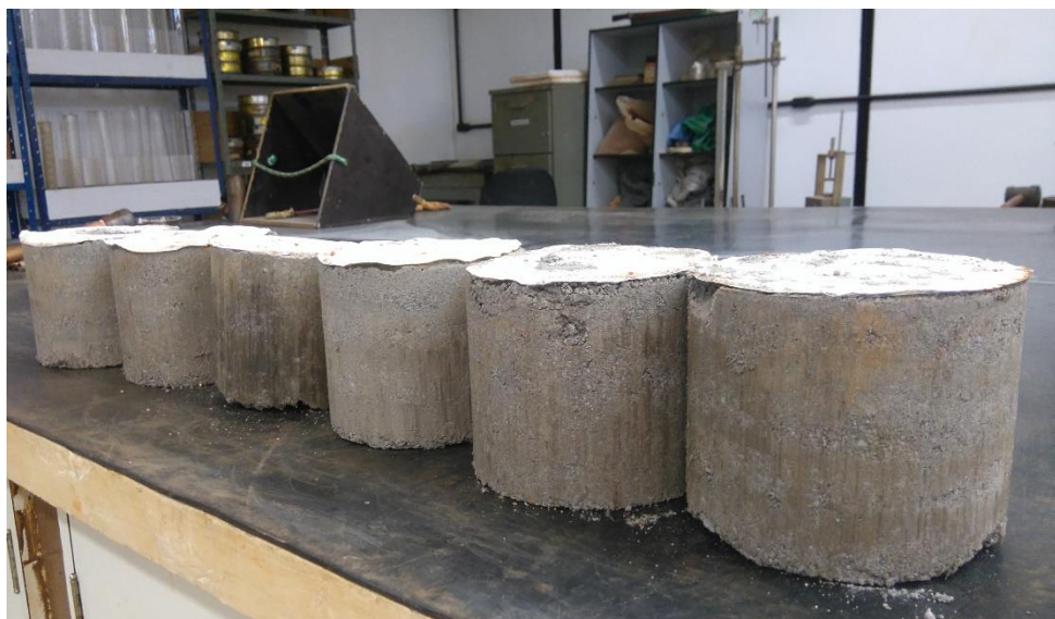
Figura 4.10 - Corpos de Prova Desmoldados Após o Ensaio de Compactação
