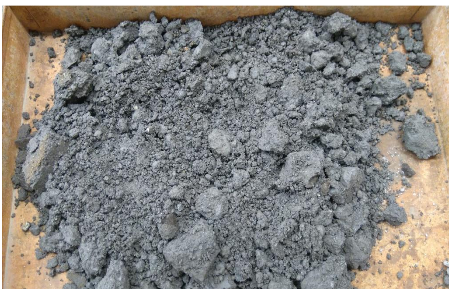
Figura 4.21 - Amostra de Açobrita Após Ensaio de Expansão
