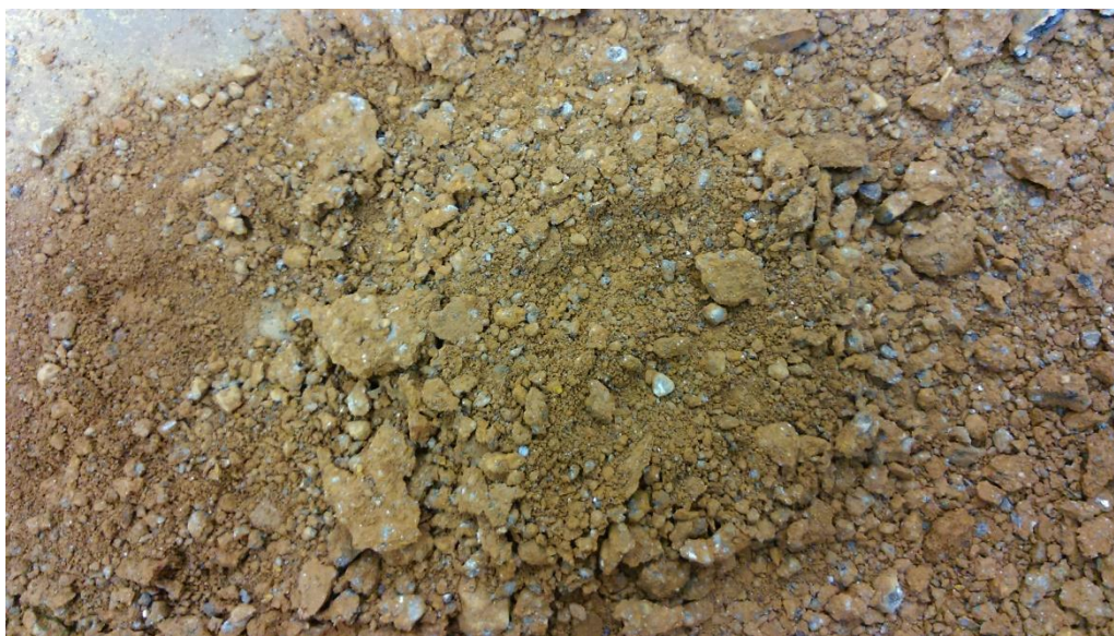
Figura 4.23 – Amostra da Mistura M8020 Após Ensaio de Expansão.
