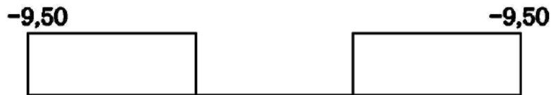
Figura 34 – Diagrama de tensões devido à subpressão
