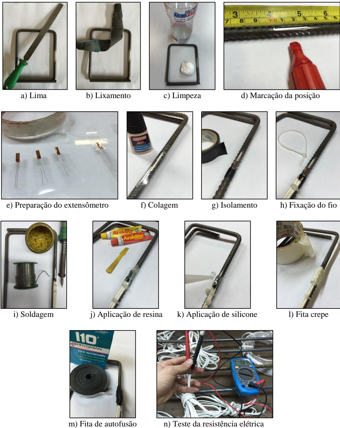
Figura 3.26 – Processo de aplicação dos extensômetros nas barras de aço
