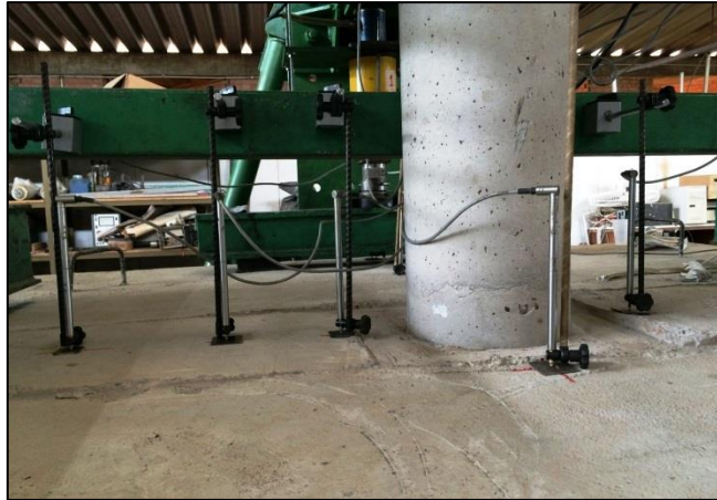
Figura 3.23 – LVDT's fixados ao suporte metálico independente
