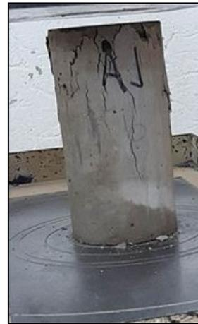
**Figura 4-21 – Corpo de prova rompido à compressão uniaxial**
