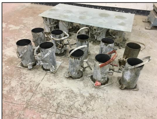
**Figura 4-17 – Moldagem dos corpos de prova de concreto**
