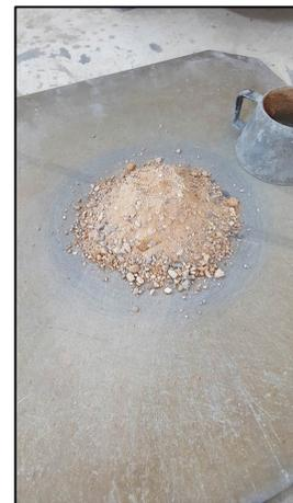
**Figura 4-13 – Amostra em condição saturada de superfície seca**
