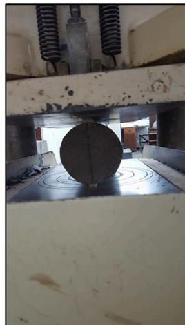
**Figura 4-22 – Corpo de prova no ensaio à tração na compressão diametral**
