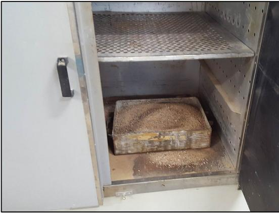
**Figura 4-7 – Secagem do agregado miúdo em estufa**
