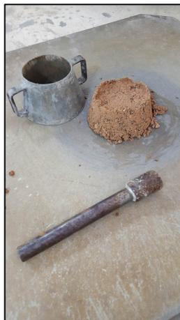
**Figura 4-12 – Amostra em condição não ideal para o cálculo de absorção**
