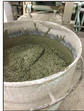
**Figura 4-15 – Traço experimental de concreto com agregado natural**
