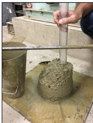
**Figura 4-16 – Teste de abatimento do concreto**
