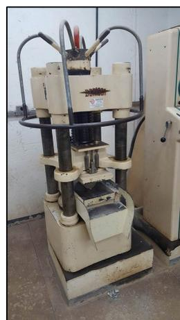
**Figura 4-19 – Prensa utilizada nos ensaios de resistência mecânica do concreto**
