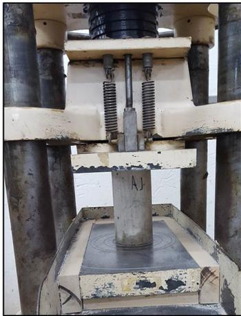
**Figura 4-20 – Corpo de prova posicionado na prensa**
