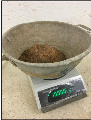
**Figura 4-5 – Amostra de areia reciclada utilizada no ensaio de granulometria**
