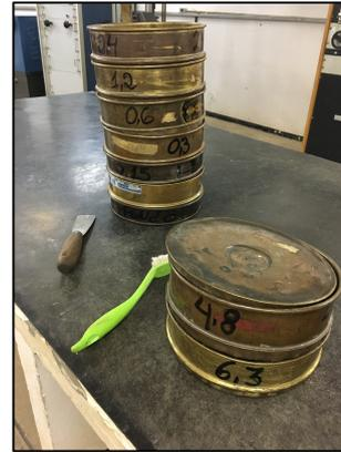
**Figura 4-6 – Série de peneira utilizadas no ensaio do agregado miúdo**
