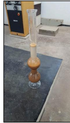
**Figura 4-8 – Água e agregado miúdo no frasco de Chapman**
