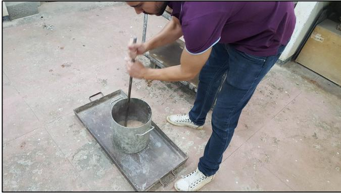
**Figura 4-9 – Ensaio de determinação de massa unitária pelo Método A**
