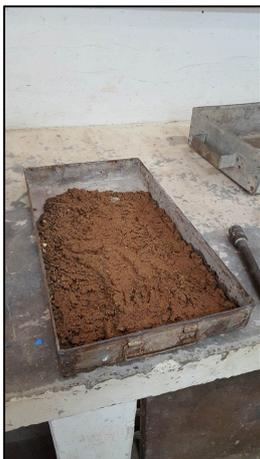
**Figura 4-11 – Amostra após saturação**
