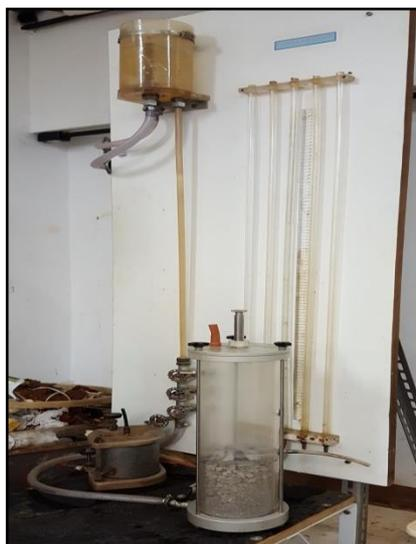
Figura 4.10 : Permeâmetro utilizado no ensaio.
