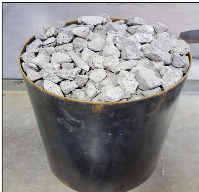
Figura 4.9: Molde cilíndrico com material utilizado no ensaio de índice de vazios.
