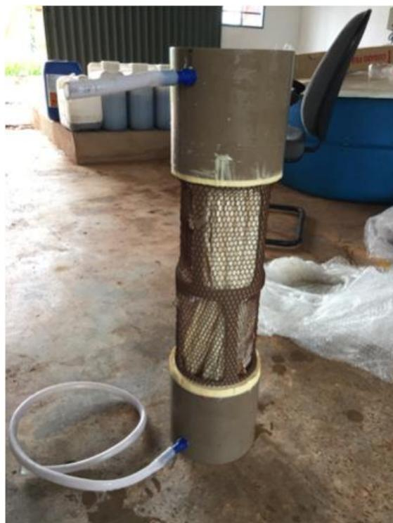
Figura 4.5 – Módulo de membrana de MFS
