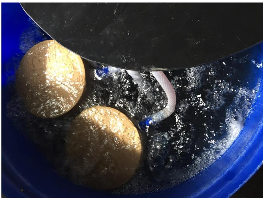
Figura 4.8 - Utilização de aeração no processo de retrolavagem
