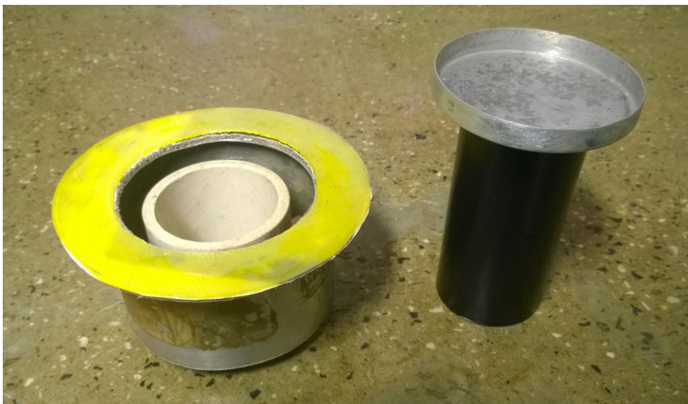
Figura 4.7 – Pedestal e anel externo utilizados no ensaio de ângulo de repouso
