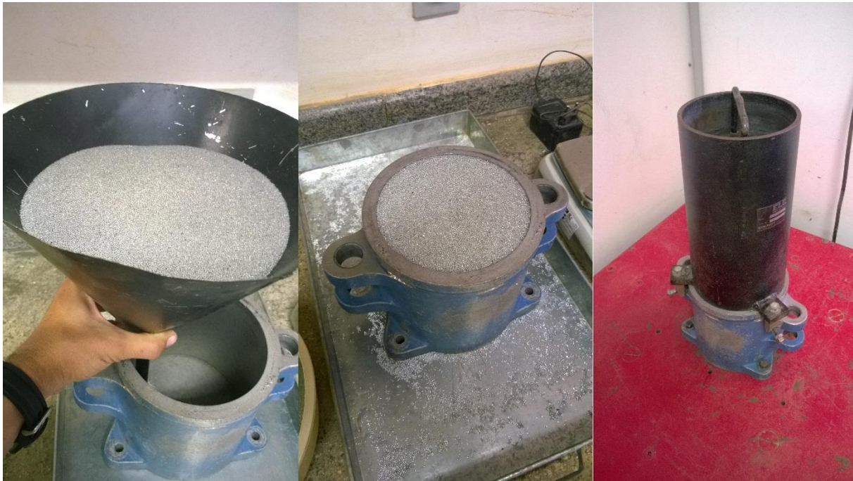
Figura 4.5 – Procedimentos dos ensaios de índice de vazios máximo e mínimo
