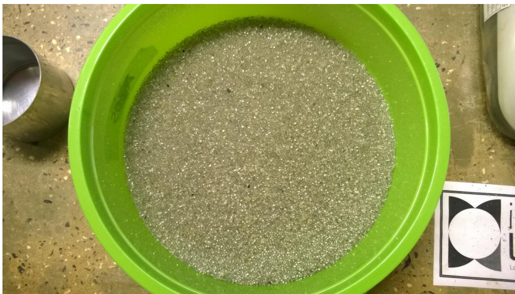
Figura 4.2 – Material estudo: Esferas de Vidro Potters
