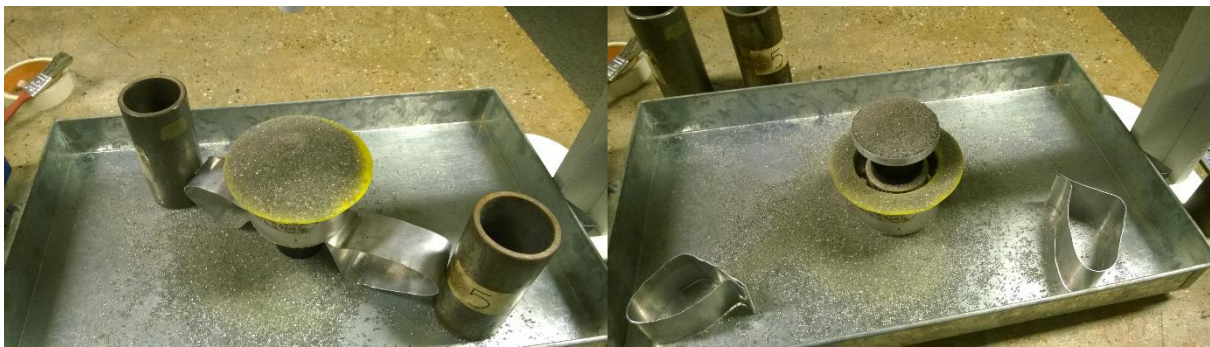
Figura 4.8 – Ensaio de ângulo de repouso: forma da pilha antes e após a ruptura
