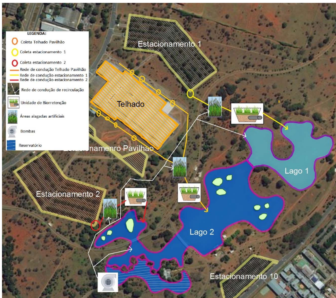
Figura 5-12 – Sistema de coleta e aproveitamento de águas pluviais proposto no trabalho.
