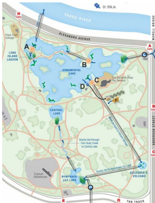
Figura 3-11 – Sistema de coleta e aproveitamento de água pluvial no Royal Botanic Garden , Melbourne, Austrália. Fonte: Clearwater, 2013.
