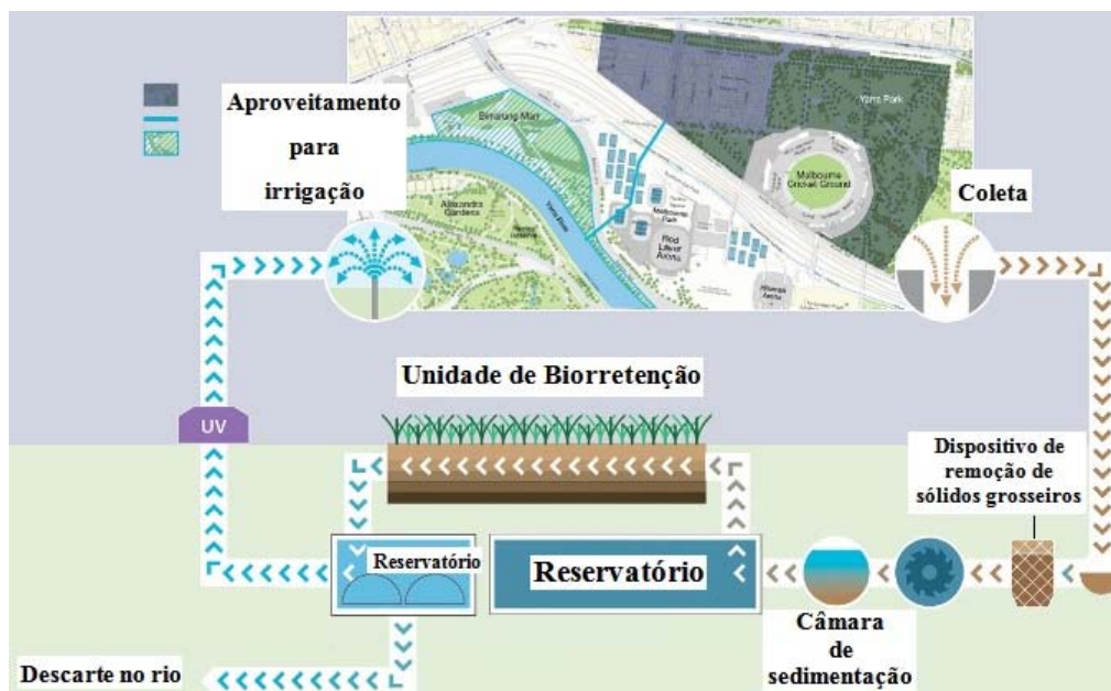
Figura 3-10 – Sistema de coleta e aproveitamento de água do Parque Birrarung Marr, Melbourne, Austrália.
