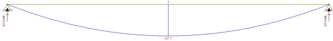
Figura 3-15 - Diagrama de esforços cortantes e momentos na viga VP04. (Figura feita por meio do software Ftool)
