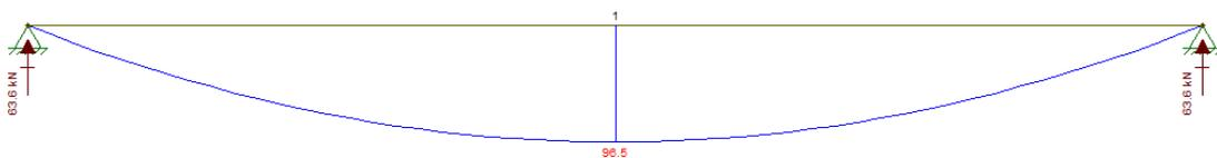
Figura 3-14 - Diagrama de esforços cortantes e momentos na viga VP02. (Figura feita por meio do software Ftool)
