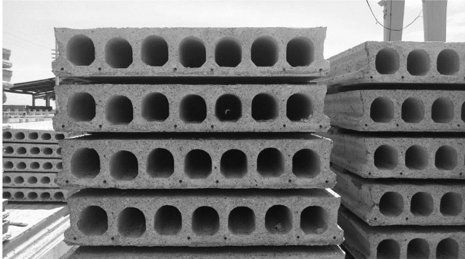
Figura 2-18- Lajes alveolares protendidas (Fábrica Tecron – Luziânia).
