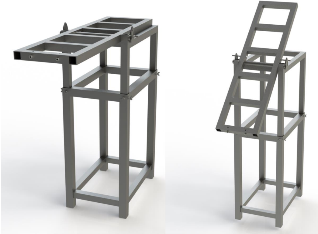
Figura 45. Desenho de montagem da estrutura completa.
