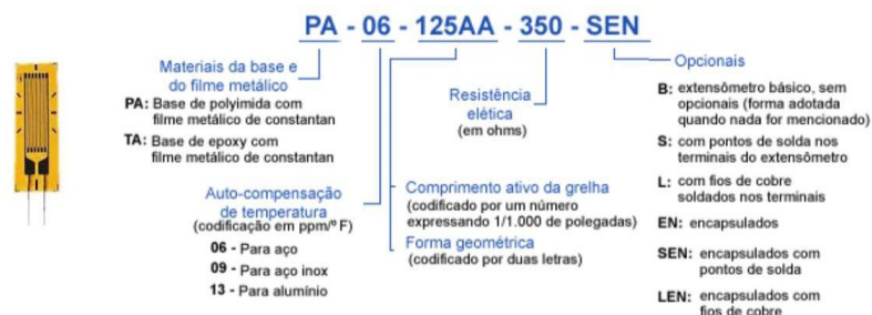
Figura 4.10 - Codificação utilizada para os extensômetros da marca Excel.
