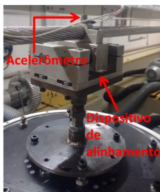
Figura 4.28 - Dispositivo de alinhamento do shaker e braçadeira com acelerômetro.
