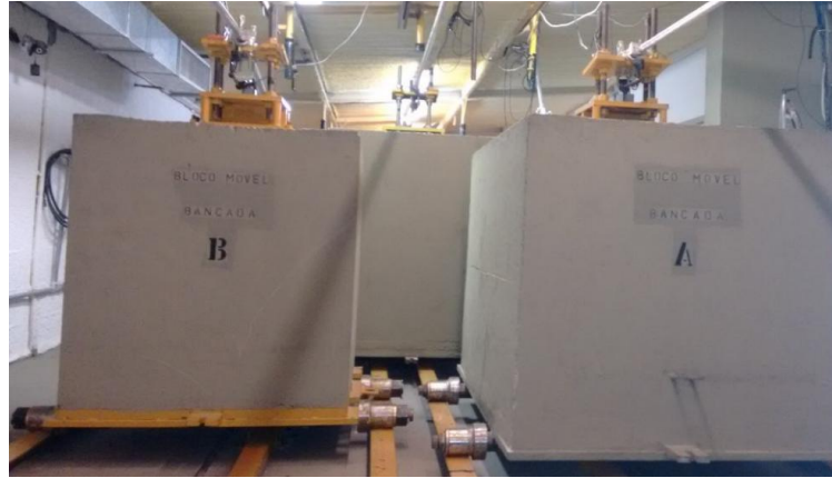
Figura 4.4 - Bloco móvel posicionado sobre eixos com rolamentos na extremidade.
