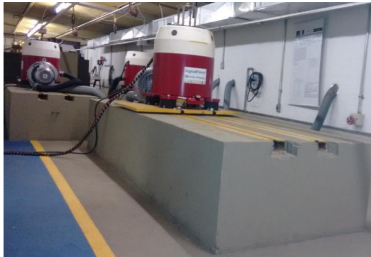
Figura 4.5 - Blocos fixos para suporte do shaker eletromecânico.
