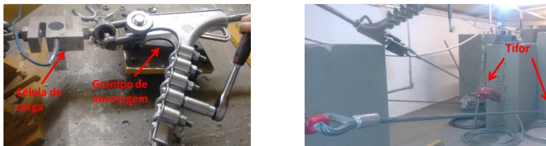
Figura 4.15 - Grampos de ancoragem conectados à: (a) célula de carga e (b) tifor.
