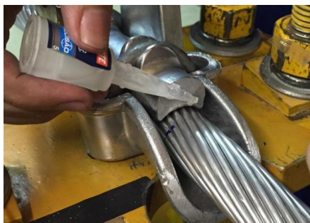
Figura 4.24 - Colocação da cola no extensômetro.
