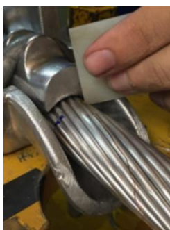
Figura 4.25 - Colagem do extensômetro.
