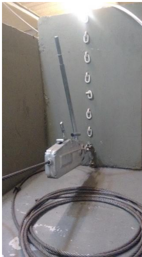
Figura 4.2 - Talha de alavanca ancorada ao bloco fixo 1.
