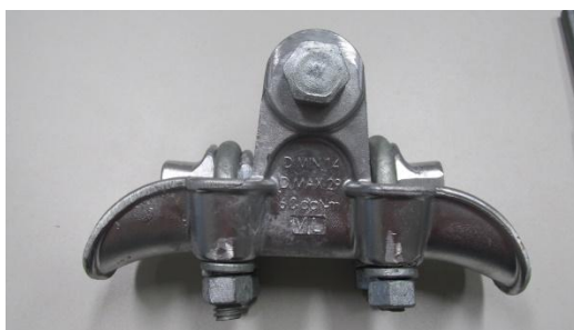
Figura 4.8 - Grampo monoarticulado utilizado nos ensaios.
