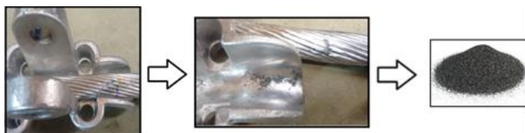
Figura 3.5 - Óxido de alumínio acumulado na superfície do grampo.
