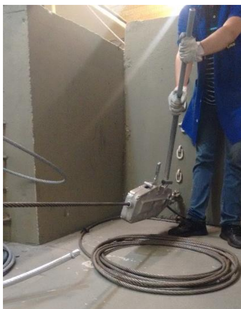
Figura 4.16 - Aplicação de pré-carga usando tifor.
