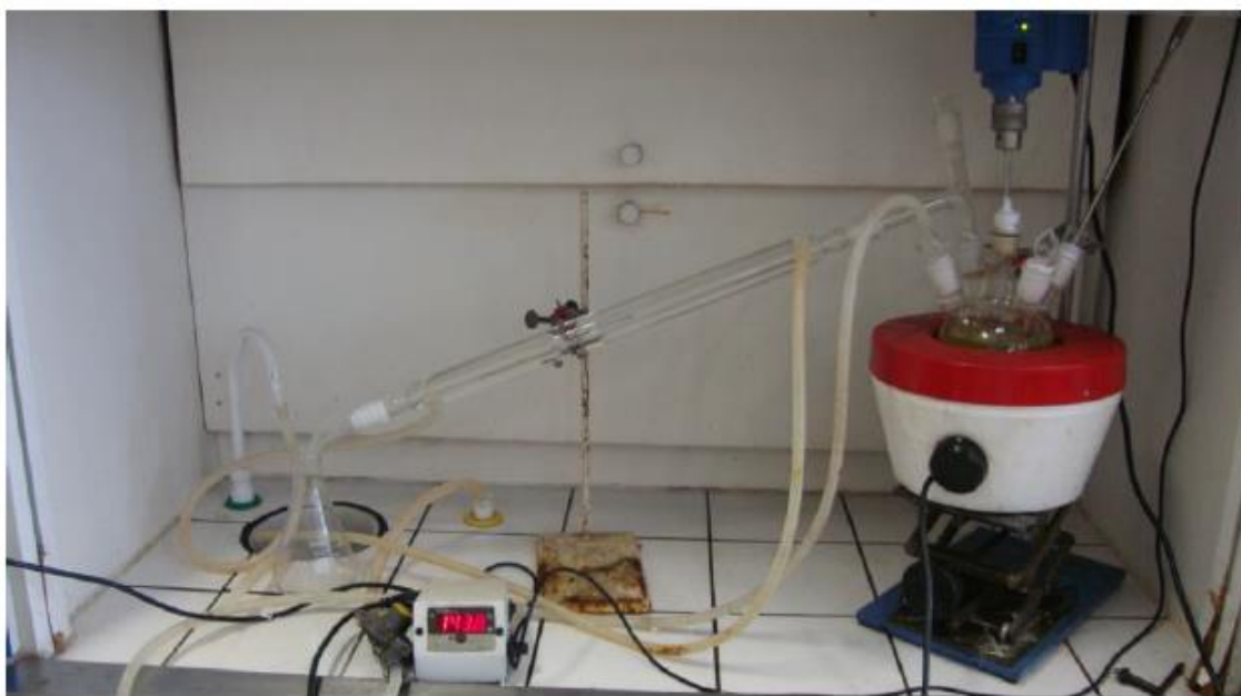
Figura 7- Montagem do sistema reacional usado na obtenção do biopolímero original.
