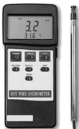
Figura 4.7 - Termo Anemômetro Digital Portátil de Fio Quente TAFR-180.
