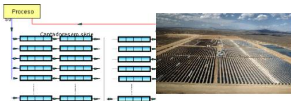
Figura 38 - Esquema e foto aérea de um campo típico de coletores cilíndrico parabólicos. (Observatorio de Energias Renováveis para a America Latina e o Caribe - ONUUDI, 2015)
