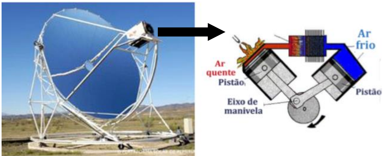
Figura 42 - A esquerda um coletor parabólico convencional e a direita o esquema de um motor Stirling. (Observatorio de Energias Renovaveis para a America Latina e o Caribe - ONUUDI, 2015)
