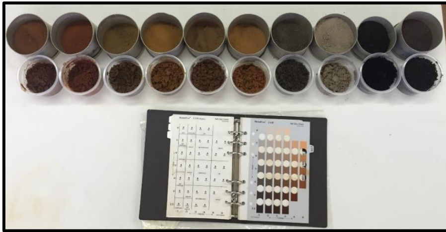
Figura 11. Leitura da carta de Munsell para amostra de solos secas e úmidas em condição de laboratório
