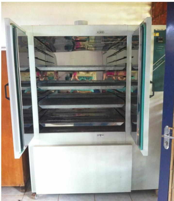
**Modelo da estufa utilizado para o método de secagem**
