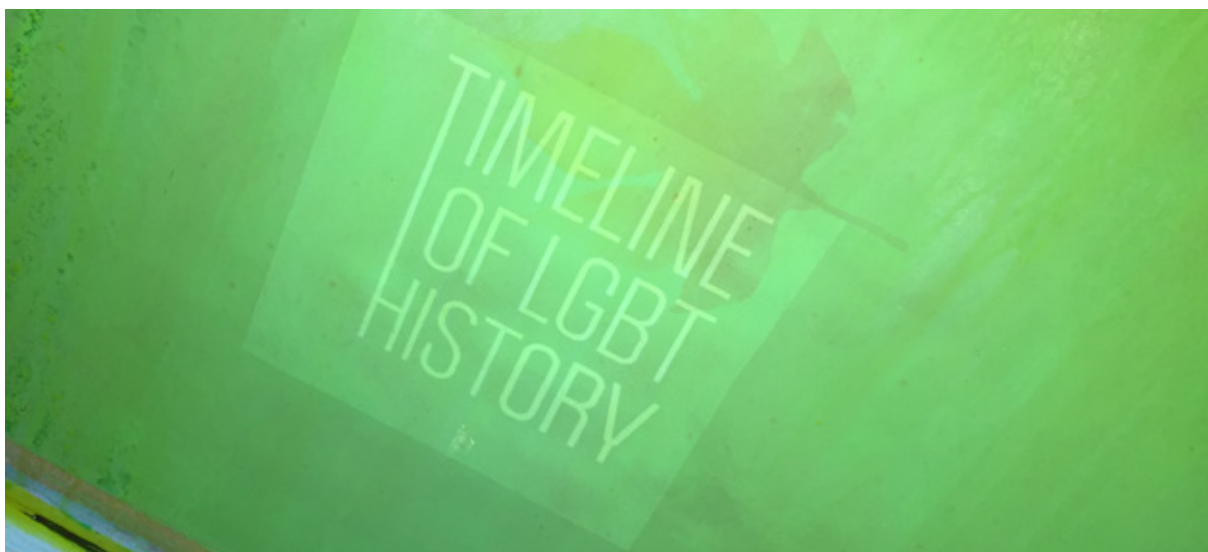
Figura 36. Tela serigráfica gravada para a impressão da capa
