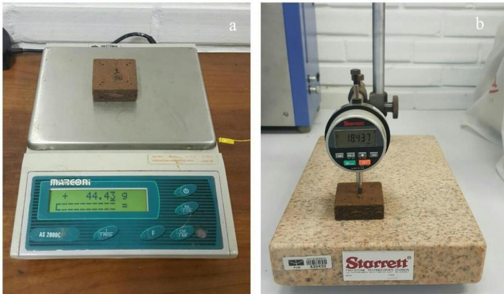
Figura 4. a) Balança eletrônica. b) Relógio comparador digital.
