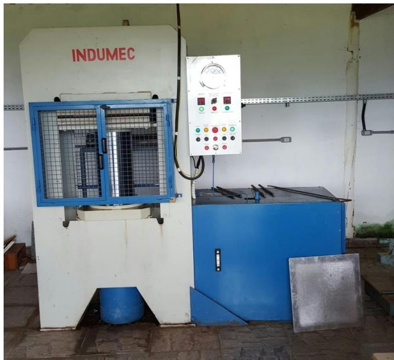
Figura 1. Prensa hidráulica utilizada nos tratamentos termomecânicos.
