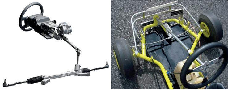
Figura 36. Diferença de complexidade entre a direção hidráulica e a direção de um kart.
