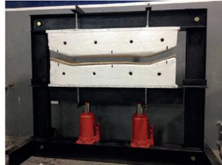
Figura 51. Prensa de fabricação de *shape* de skate
