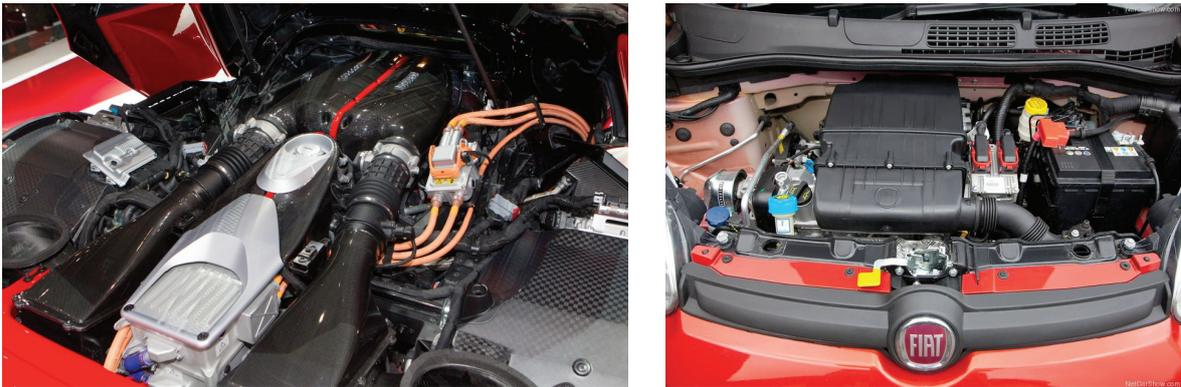
Figura 5. Comparação de motores entre os modelos LaFerrari e Fiat Panda.
