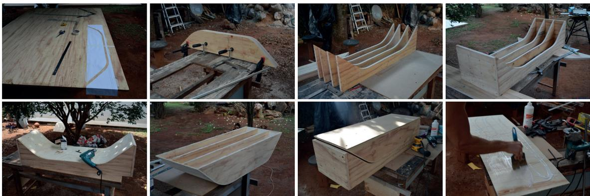
Figura 70. Processo de fabricação do banco e seu molde.
