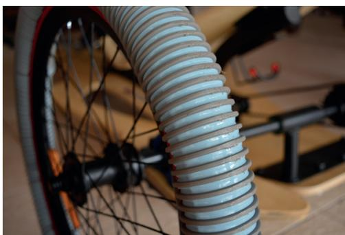
Figura 74. Detalhe do pneu revestido com a mangueira plástica para derrapagem.
