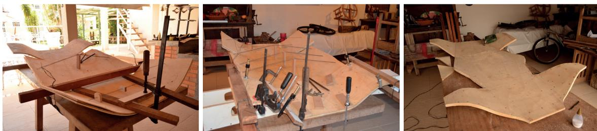
Figura 69. Processo de fabricação da carenagem.
