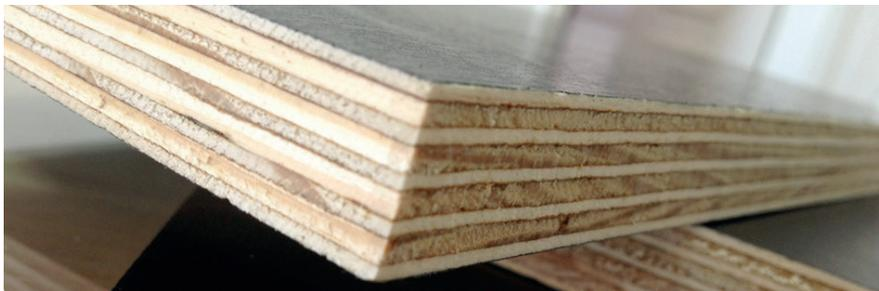
Figura 50. Compensado feito com 9 lâminas
