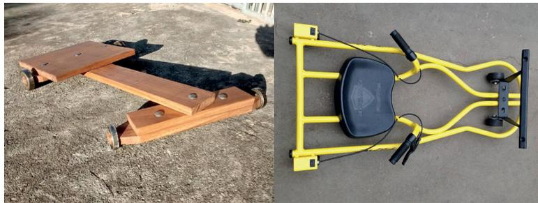
Figura 29. Carrinho de rolimã clássico e modelo mais moderno com manete e freio
