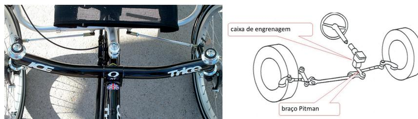
Figura 22. Comparação do sistema de direção do quadriciclo reclinado e de um carro.
